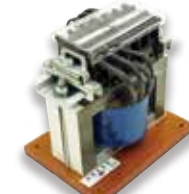
EC120タイプ (6kVA 100kHz)
